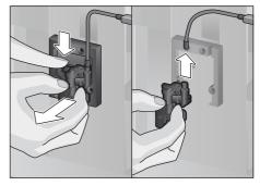
Extraer el tubo de la leche. Desmontar la parte superior y la parte inferior del dispensador de bebidas.
