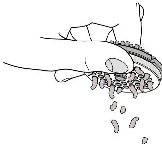
El cuerpo de la picadora de alimentos, la cóclea, la tuerca de fijación, la cuchilla y los tres discos perforados no pueden ser lavadas en lavavajillas, si no que deben ser lavadas a mano con agua templada y jabón neutro.
