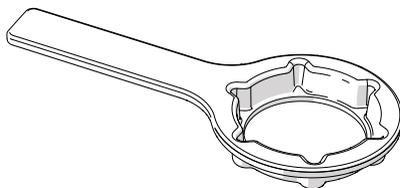
Facilita la fijación o la eliminación de la tuerca.
