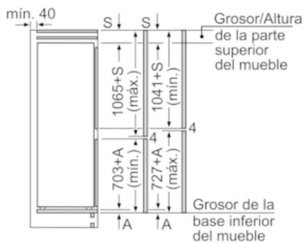
Las dimensiones de la puerta del mueble corresponden a una junta de puerta de 4 mm.
