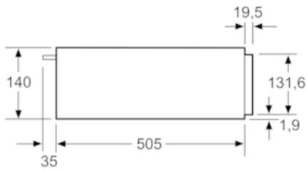
Los hornos compactos con una altura de 455 mm se pueden montar sobre un cajón calentaplatos. No es necesaria una balda intermedia.
